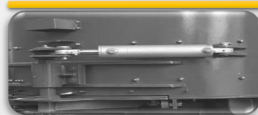
Разгрузочный затвор, цилиндр и подшипник
